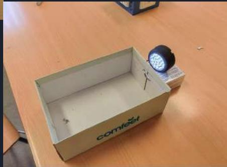
A partir de una caja de zapatos hacemos un abujero en la cara frontal y trasera, uno de ellos en los que se le introduce un foco de luz y otro para observar el fenómeno.
